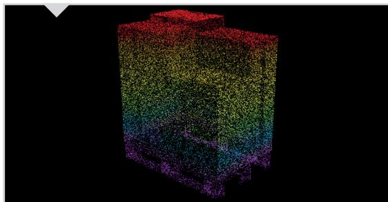
Anhand des erstellten 3D-Profiles werden die Abmessungen und das Volumen der Ladung bestimmt.
