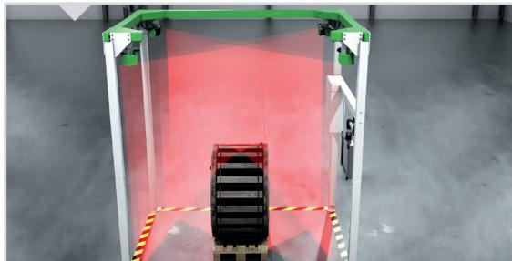
Die Fracht wird entladen und in einem vordefinierten Messbereich gescannt.
