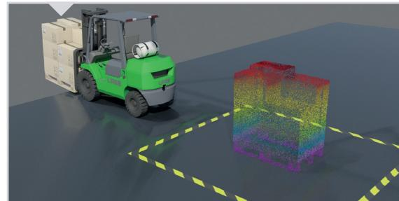
Die Applikation erstellt einen Quader, der das Frachtstück „umschließt“. Dies sind die maximalen Abmessungen.
